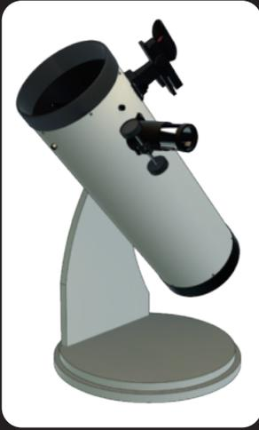
**Figure 4** – Un Dobson miniature de table représente une intéressante alternative aux lunettes achromatiques. Délivrant une image de meilleure qualité et installé sur une monture stable, d'un maniement extrêmement simple, il est toutefois nécessaire d'en régler les miroirs de temps à autre. Il est équipé d'un chercheur classique ou à point rouge (comme ici) pour viser les astres lumineux.
